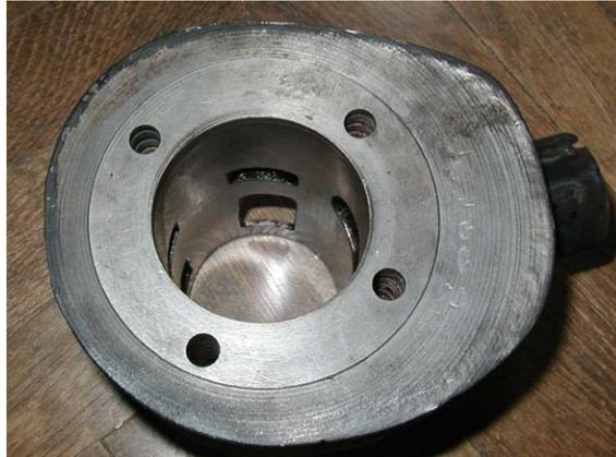
abgedrehter zylinder mit kleiner abstufung als auflage für den zylinderkopf
