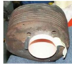
dann alle kanten der schlitze aufs papier andrücken später nachmalen oder mit bleistift innen drübermalen – so bilden sich die kanäle ab und man erhält ein abbild der zylinder innenfläche:
